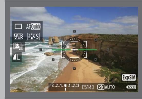
Nivelador electrónico en LCD para tomas precisas.
