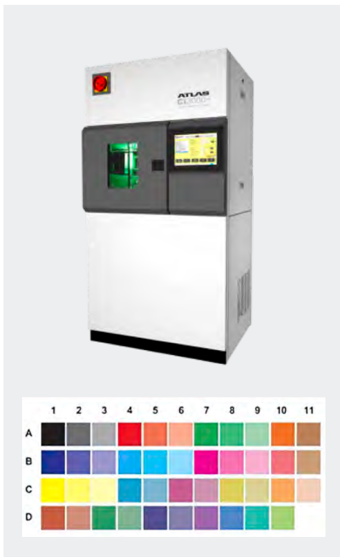
FIGURA 28: Cabina de pruebas aceleradas y tabla de prueba de solidez a luz CMYK
