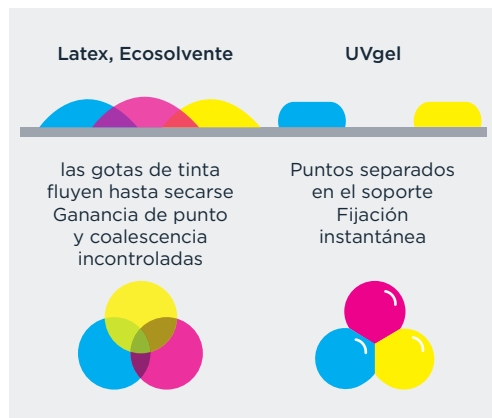
FIGURA 10: Coalescencia en el proceso evaporativo (1.6 m latex/ecosolvente) y UVgel
