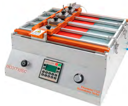
FIGURA 25: Comprobador de lavabilidad Elcometer 1720
